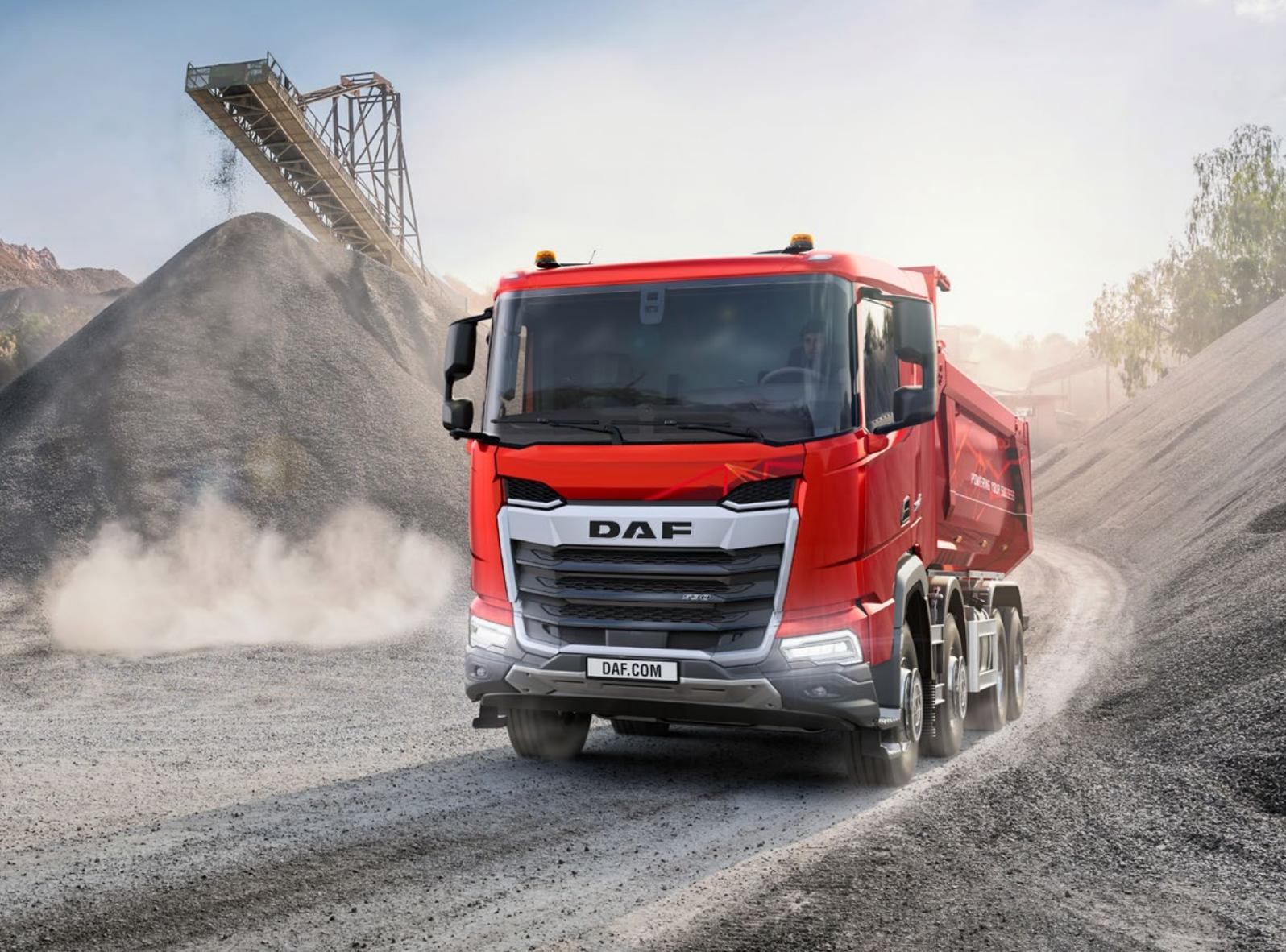
Der 3-teilige Stoßfänger aus Stahl und die Kühlerschutzplatte sind sehr robust, wodurch das Risiko minimiert wird, gefährdete Teile vorn am Fahrzeug zu beschädigen.
